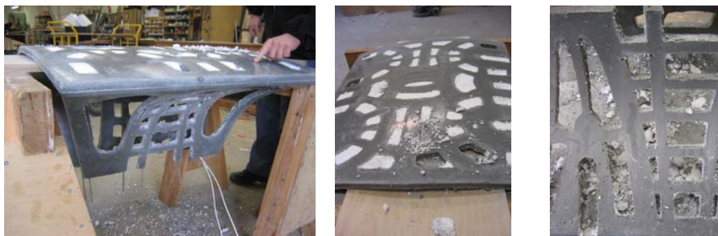
Figur 2. Afformning af en af de støbte møbler ved Dalton Betonelementer. Billeder Anja Bache.
