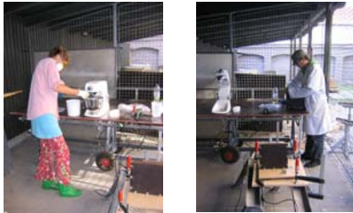
Figur 6. På Statens Værksteder for Kunst og Håndværk oprettede vi et betonværksted bestående af en 5 liters betonblender og en kuglevibrator. Billeder Claus Hviid Knudsen og Anja Bache.
