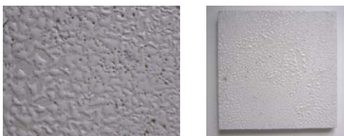
Figur 16. Eksempler på brændinger med glasur i ny beton. Billeder Anja Bache
