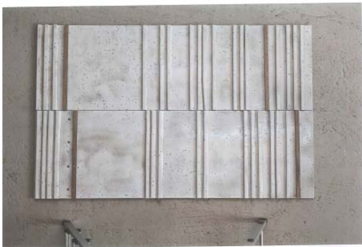
Tilsvarende og følgende side: Prototyper i glasret betone. Alle fotos Ole Almqvist med tilladning fra: Prototyper in glass concrete. All photos Ole Almqvist
